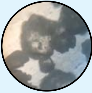
आकृती 5 10× वस्तुभिंगाखाली मिठाचे कण Figure 5 Salt under a 10× objective lens
