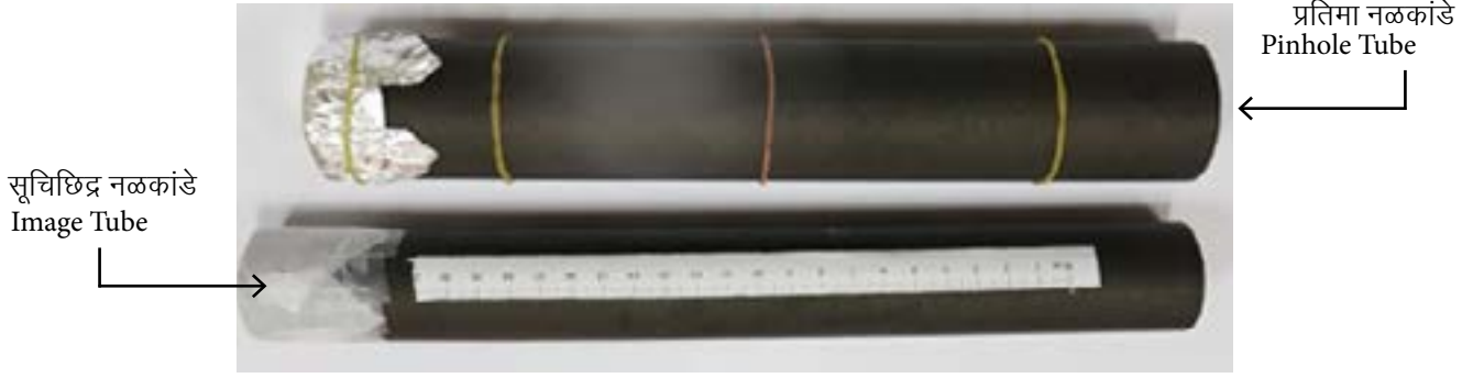
आकृती 4 सूचिछिद्र नळकांडे (PT) आणि प्रतिमा नळकांडे (IT) Figure 4 Image Tube (IT) and Picture Tube (PT)
