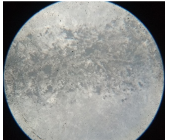
Figure 2: Pencil line under a 10X objective lens आकृती 2: 10X वस्तुभिगाखाली पेन्सिलची रेषा
