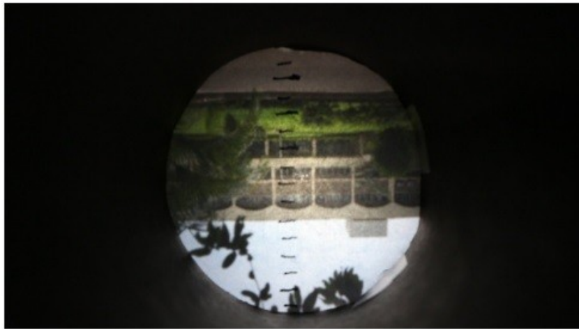
Figure 6(b): Image in pinhole camera आकृती 6(ब): सूचिछिद्र कॅमेऱ्यात वस्तूची उमटलेली प्रतिमा
